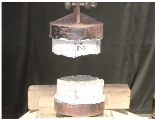
写真-2 直接引張強度試験
