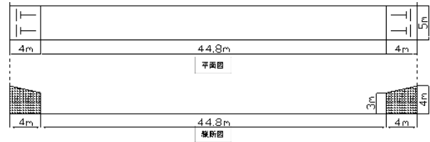
図-4 実験ピットの形状（平面図，縦断面図）
