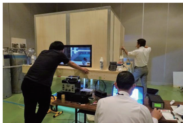
⑥ 実験の様子 目地をアルミテープで塞ぎ，室素置換時の気密性を確保，マイクの設置は，側壁と客席下面に設けた穴から所定の位置に到達するようにした。室素置換時の空気濃度と測定時に酸欠にならないよう酸素濃度計を室内にも設置した。
