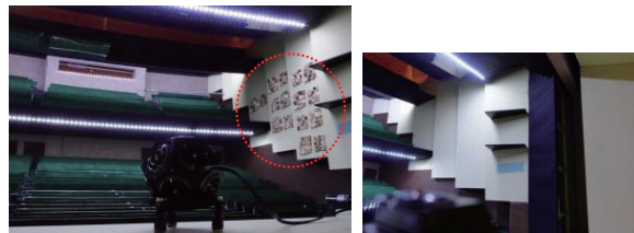
左：○部に拡散取り付け、右：拡散なし
