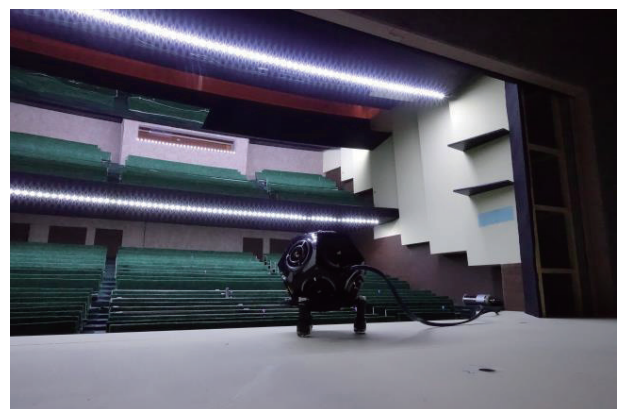
図-20 反射板なしの測定状況（上：実物，下：模型）
