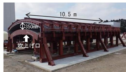
図－2 実験用模擬型枠外観
