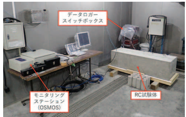
写真-1 試験体の養生時の状況
