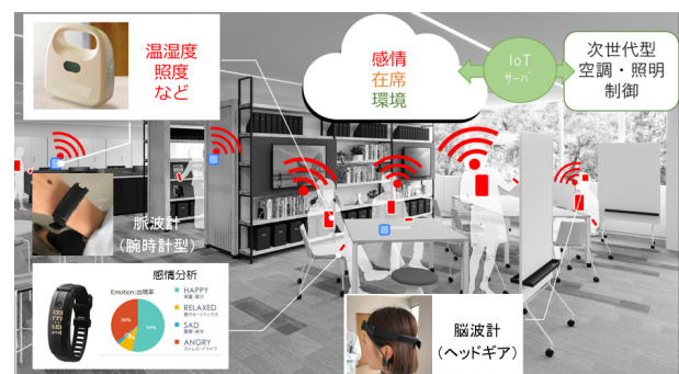
図-1 感情変化を利用したオフィス空調制御システムのイメージ
