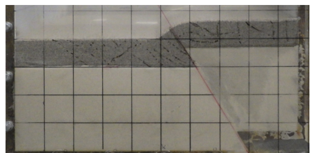
(b) 構造物なしケース (4K-10-5-0) の実験結果
