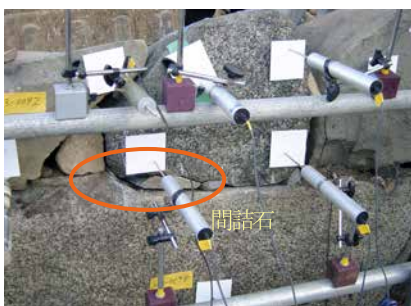
(1) 打ち込み接ぎ (原位置)
