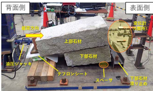
写真-5 築石設置角度の影響評価実験状況
