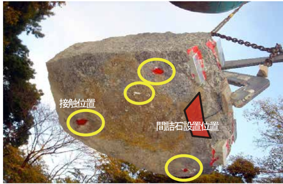
写真-2 石材間の接触状況 (摩擦実験終了後)
