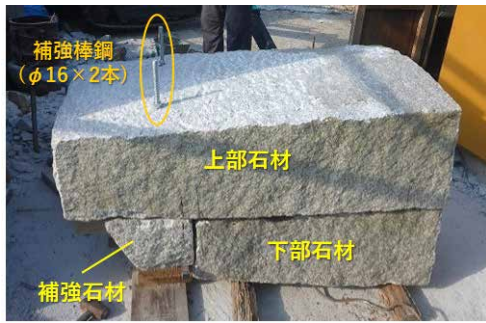
写真-6 逆石補強方法
