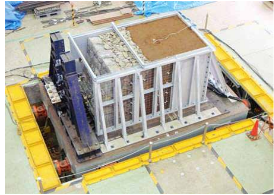
写真-7 実物大石垣の振動実験の概要
