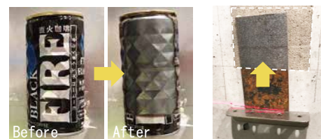
写真-2 凸凹面の塗膜除去（左）、錆び落とし（右）
