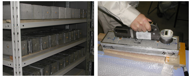
写真5 乾燥収縮ひずみ試験体 写真6 コンタクトゲージ法による長さ変化試験
