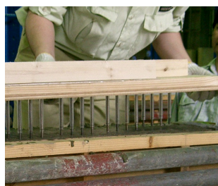
写真3 含水率測定用のプローブ挿入孔設置
