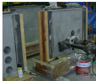
写真2 壁模擬試験体コア採取状況
