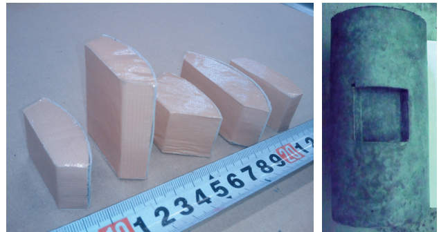
写真1 欠損形状と試験体出来形
