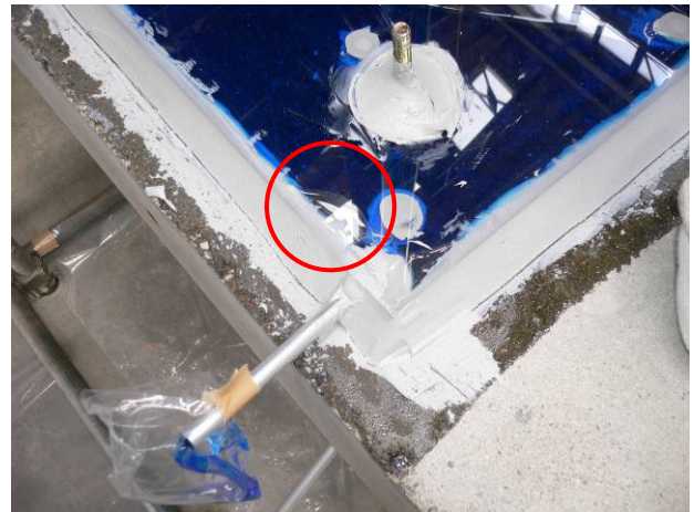
写真 5 試験体 B1(排出孔⑥の横に気泡)
