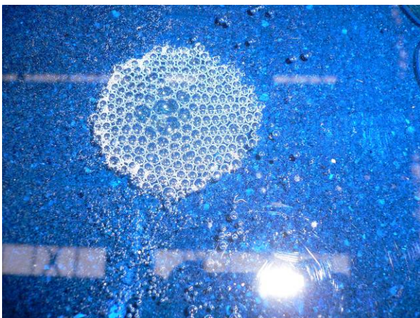
写真 15 微細気泡(一般平滑部)
