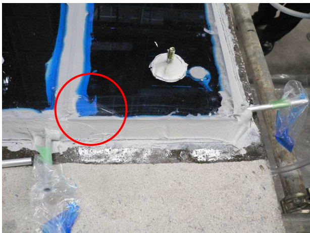
写真8 試験体 C1,C2(注入後 C1 隅部気泡)
