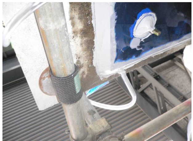
写真11 試験体 C4(注入後 隅部気泡なし)
