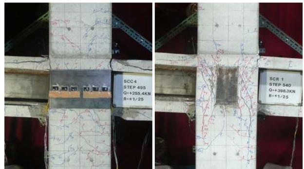
写真1 破壊状況例(R=1/25rad.時)
