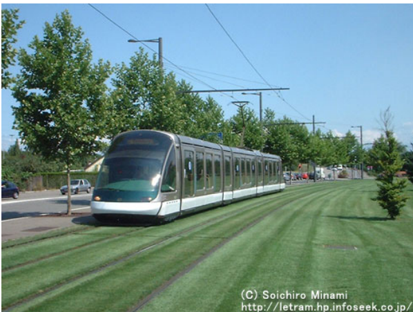
写真－1 フランス ストラスブールの LRT と軌道緑化
