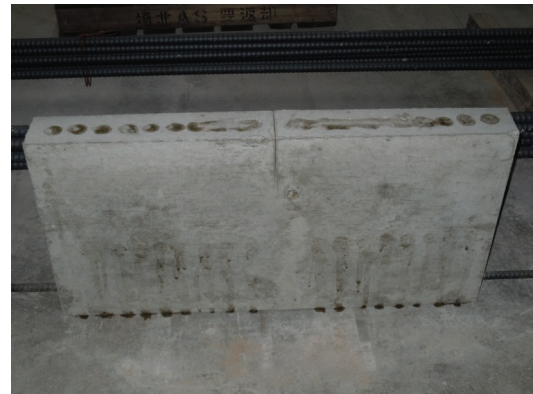
写真-1 ひび割れ模擬試験体の一例写真 (ひび割れ幅：0.8mm，ひび割れ深さ：150mm)
