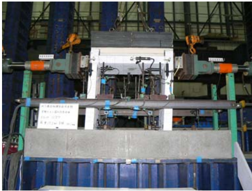
写真-1 試験体変形状況 (改良体無し, +10 δ y 载荷時)
