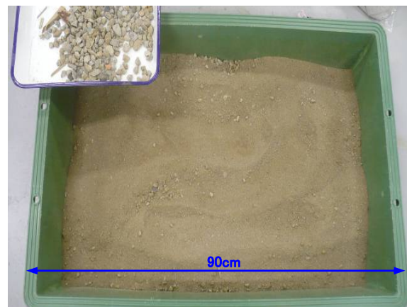
写真-7 試験に用いたコンガラ(9.5mm通過分)
