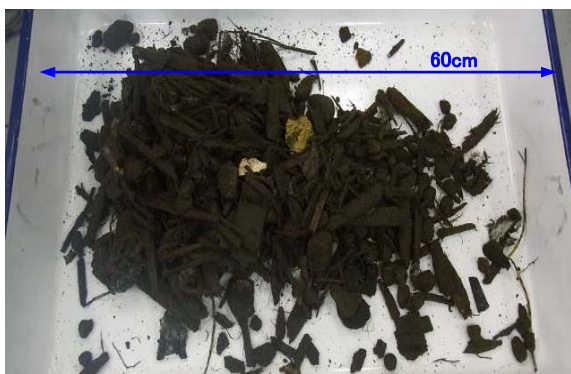
写真-4 ふるい下の土砂分から除去した夾雑物
