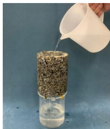
透水性地盤改良体
