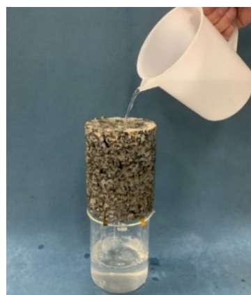
透水性地盤改良体
