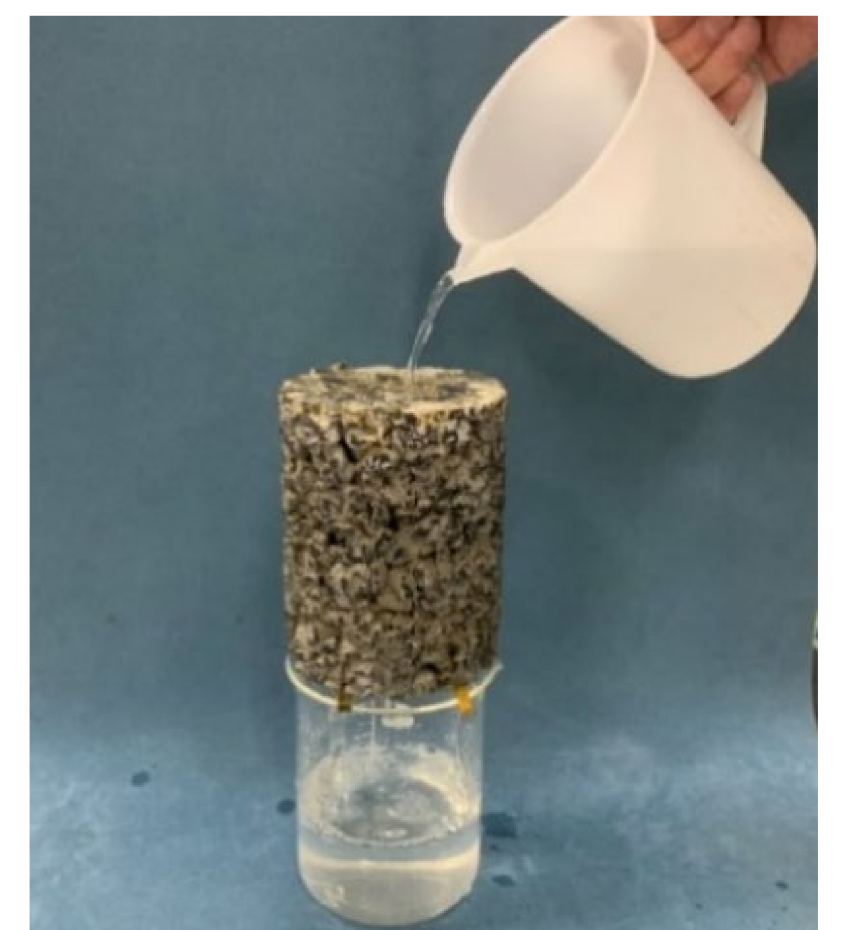
透水性改良体 透水係数 k=1.0 \times 10^{-3} \text{m/sec}
