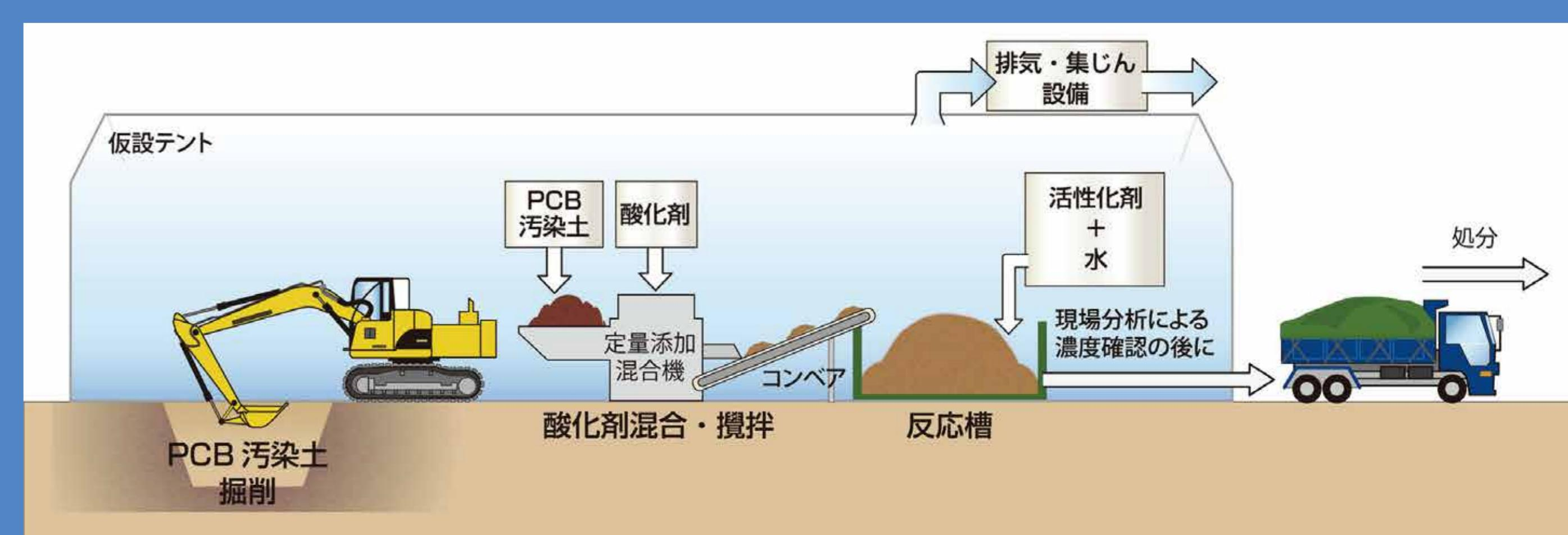
酸化剤によるPCB汚染土壤の浄化イメージ
