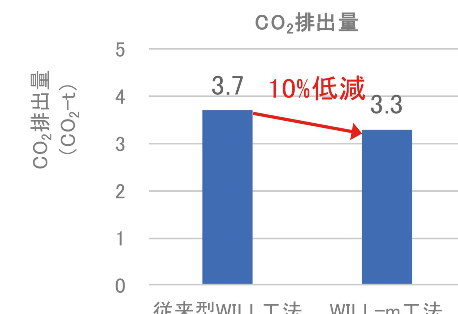
WILL-m工法の適用効果(粘性土5,000m<sup>3</sup>程度以上)
