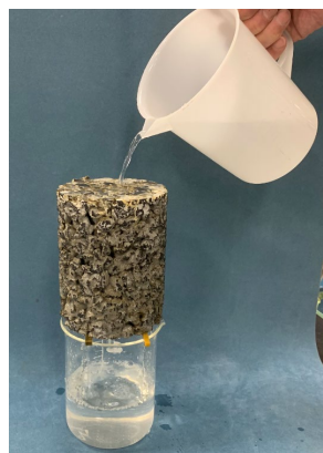
透水性地盤改良体 k=1.0 \times 10^{-3} \text{m/sec}
