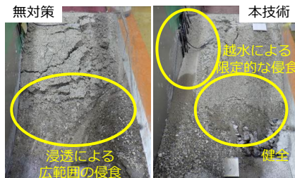
破堤後の様子 (条件B)
