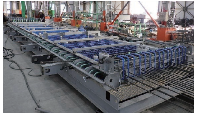
図 プレキャストPC床版製造状況
