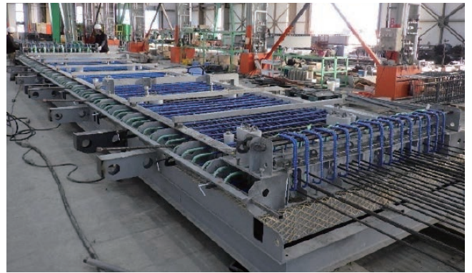
図 プレキャストPC床版製造状況
