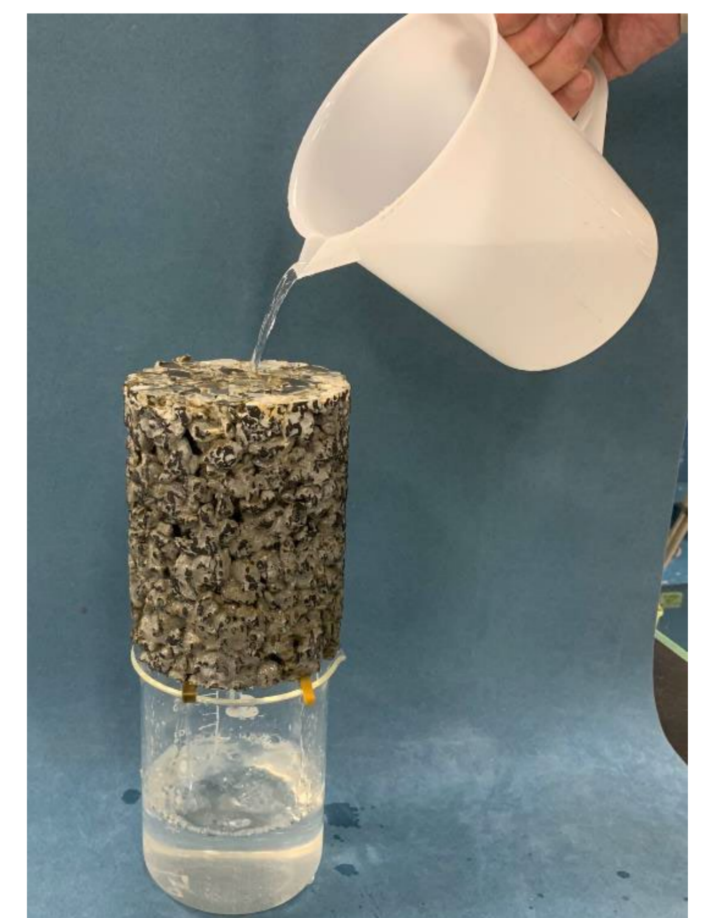
透水性改良体 透水係数 k=1.0 \times 10^{-3} \text{m/sec}
