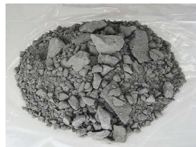
路盤材（破碎材）
