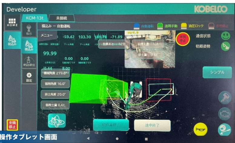
自動運転ショベルによる積込作業
