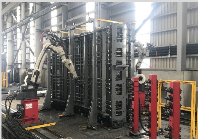
ロボットによる鉄筋の自動溶接
