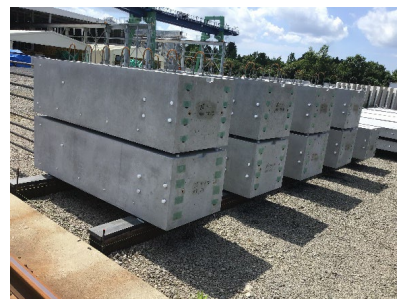
低炭素型プレキャストコンクリート 品質・コストは従来と同等以上で 低炭素性を実現
