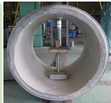
20mm減肉試験体を破壊後、本工法で更生したマンホール側塊の側方曲げ試験状況
