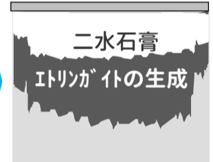
コンクリート表面
