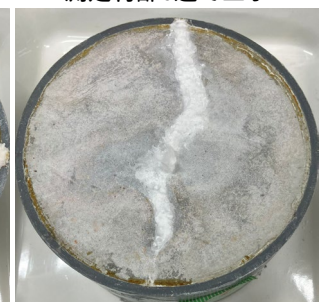
ひび割れ幅：0.28mm 測定材齢6週で止水
