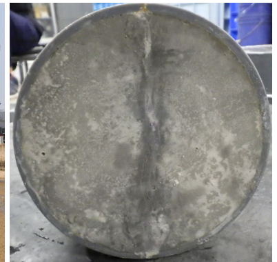
実験終了時（自己治癒完了） ひび割れ幅0.25mm、漏水量0mL
