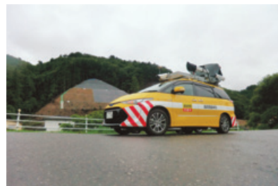
MMSによる工事現場の計測（MMSで切土面を計測している様子）
