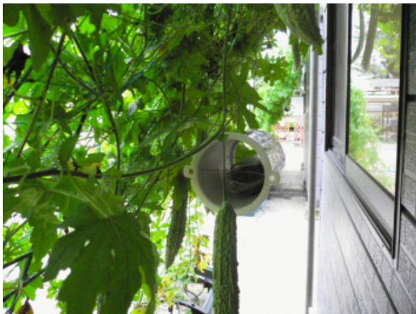
写真-3 おんどり設置状況 (試験A-グリーンカーテン内気温計測時)
