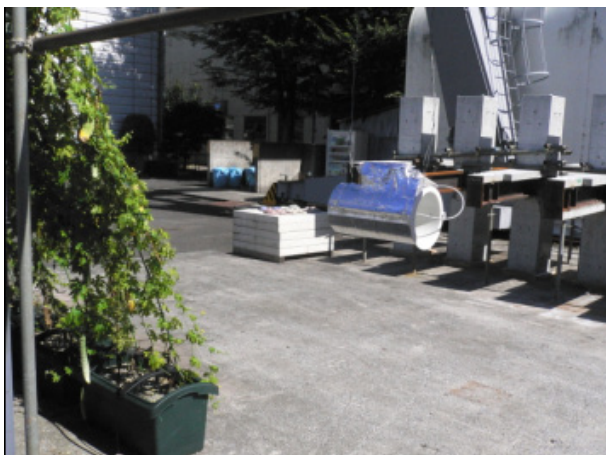
写真-4 おんどり設置状況 (試験A-外気温度計測時)
