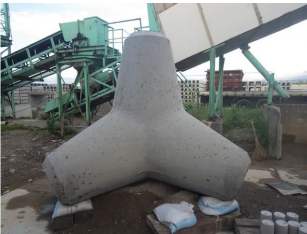
写真-10 浚渫砂混合アッシュコンクリート
