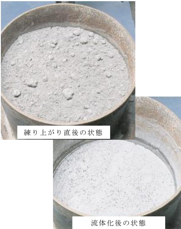
写真-1 締めによる流体化前後の状況
