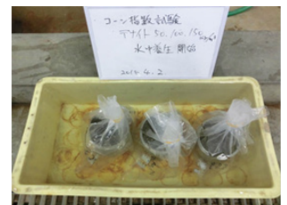
写真-4 水中養生状況
