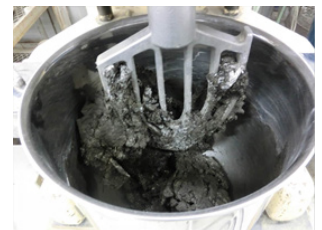
写真-2 改良材混合状況
