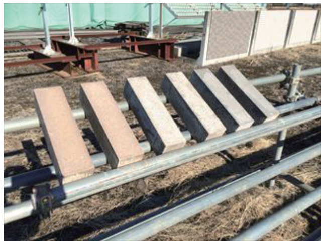
図-6 屋外曝露試験状況
