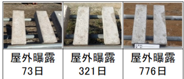
b) ケースA-5 セメント添加量15% (外割) 焼却灰：飛灰：混和材 = 25：75：0
