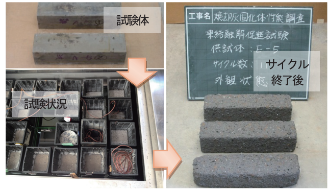
図-4 凍結融解試験状況
