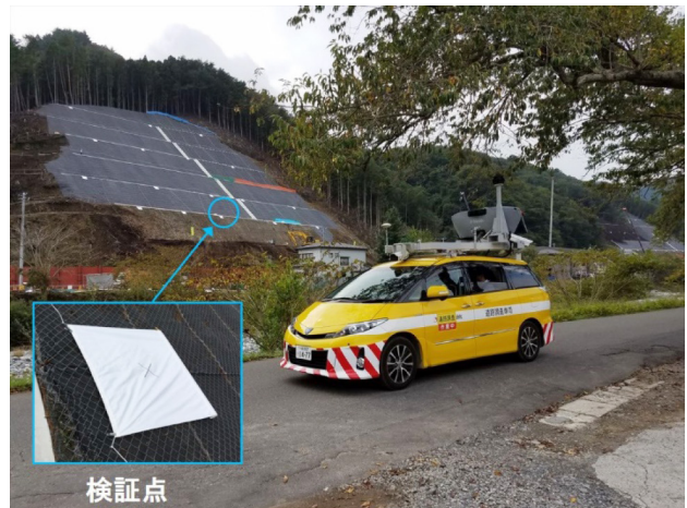
切土法面工事の現場を走行するMMSと検証点
