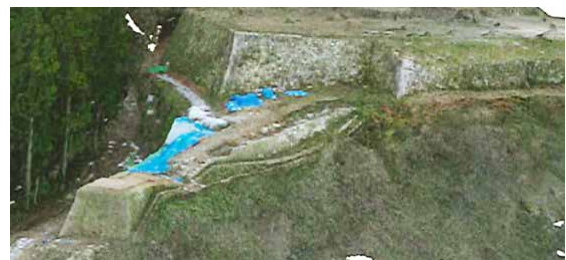
図-1 UAV撮影画像による石垣の3次元モデリング
