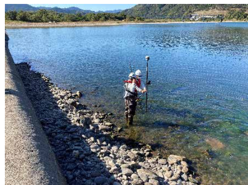
図-15 VRS-GNSS計測状況
