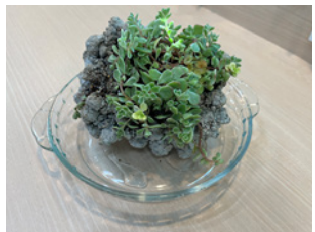
写真－5 多肉植物（セダム）の緑化コンクリートへの植栽例
