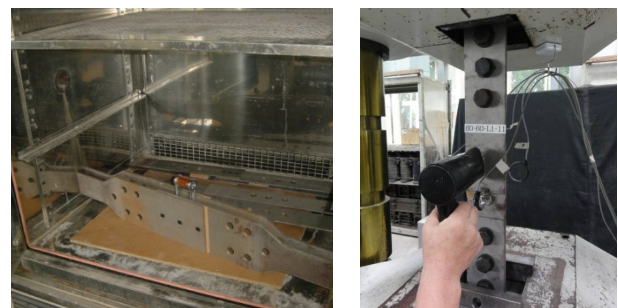
(a) 恒温槽で加熱 (b) ドライヤーで加熱
