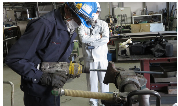
写真－1 第2・3段階の加工状況（一次・二次切削）
