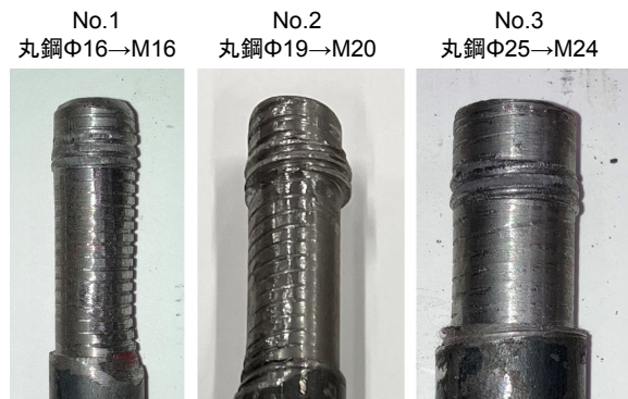
写真-3 実験後の外観 No.1~3 (高ナット SS400)
