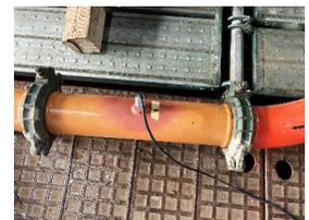
写真-2 管内圧力計測
