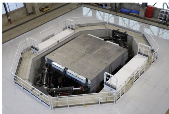
写真－1 大型三軸振動台の全景
