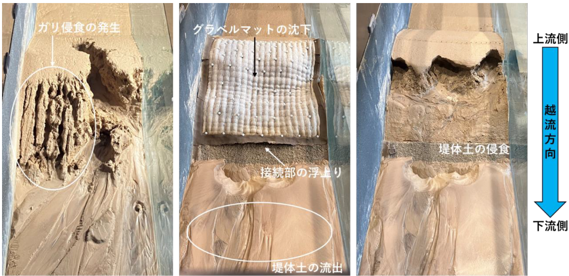
写真－8 実験終了後の模型下流側法面の状況 （左：無対策，中：対策有，右：対策有（被覆工撤去状況））
