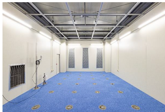
写真-1 屋内環境試験室
