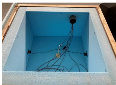
写真－11 断熱性能試験（例） 試験体内仕様
