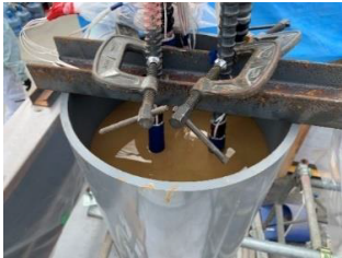
写真-1 鉄筋の安定液への浸漬状況
